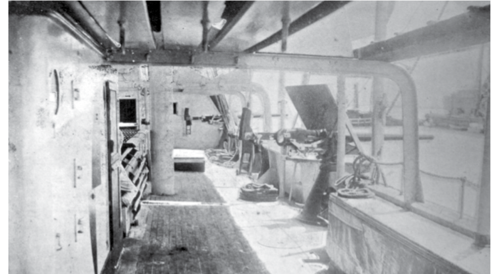
Ilustración 5 Cubierta del cañonero "Veracruz", mostrando cañones de tiro rápido sistema Bethlehem
